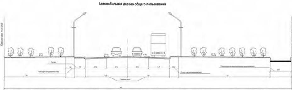
Рис.1. Поперечный профиль автомобильной дороги общего пользования.
