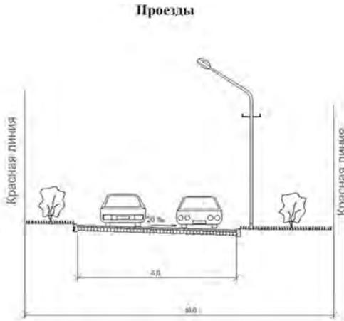
Рис.2. Поперечный профиль внутриквартальных проездов (переулков).
