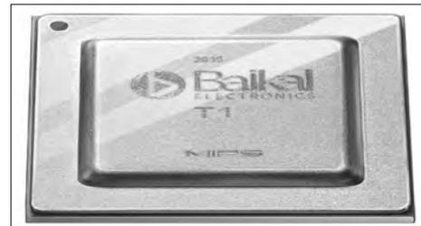
Компания «Байкал Электроникс» представила чип в мае 2015 года. Он позиционируется как первый российский процессор, созданный на основе 28-нанометрового технологического процесса. Кроме того, чип призван стать первым российским процессором, который изначально создан не для оборонных задач, а для коммерческих нужд.
